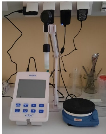
Obrázok 1.3 Ukážka štandardného pH metra so sklenou elektródou používaného v laboratóriu in vitro systémov. (Zdroj: autori).
