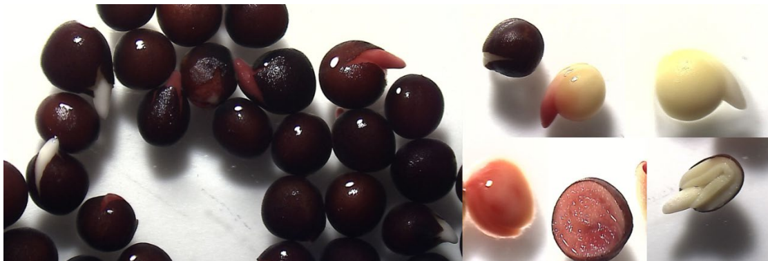
Obrázok 3.4 Ukážka výsledku testu životaschopnosti semien repky olejnej pomocou 2,3,5 trifenyl tetrazolium chloridu (Zdroj: autori).
