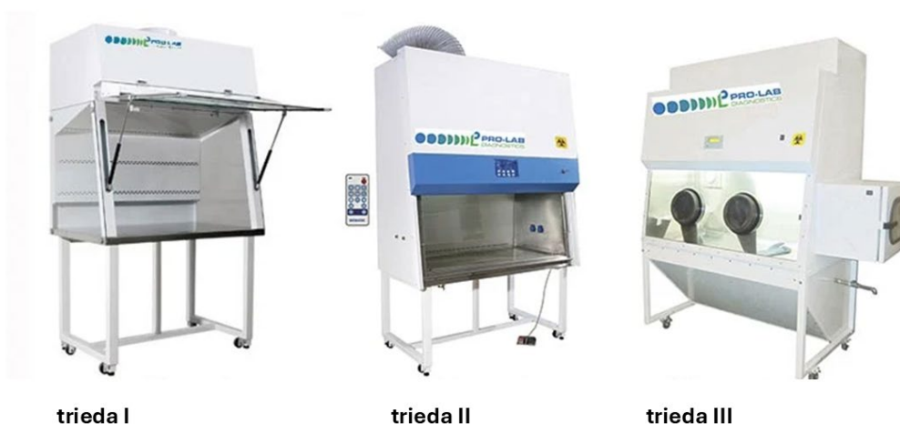
Obrázok 1.7 Ukážka biologicky bezpečných kabinetov triedy I, triedy II a triedy III. (Zdroj: https://microbenotes.com/biosafety-cabinets/ , upravené).
